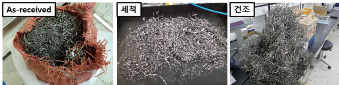
[Ti New scrap 의 침지 방식의 전처리 공정 사진]
