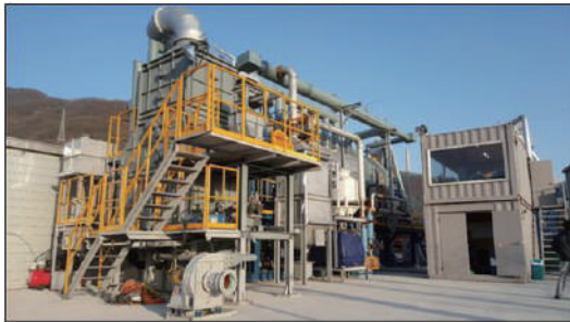
〈 Pilot Plant(10톤/일) 반탄화 시스템 전경 및 중앙제어실 HMI 화면〉
