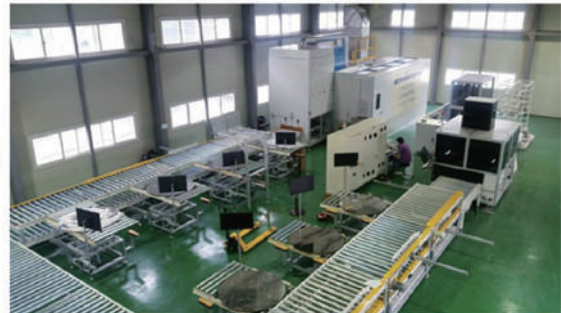
[그림] 5,000 TPY급 페디스플레이 해체/선별 자동화 시스템
