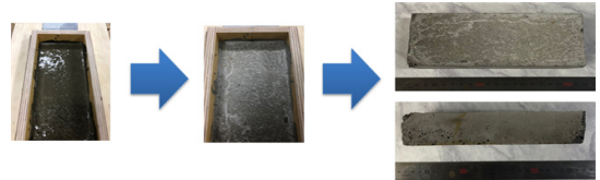
[시멘트와 슬래그만으로 벽돌제작 가능성 확인]
