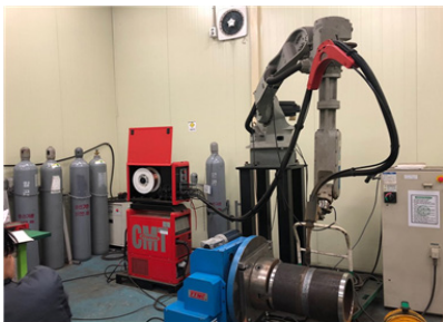
[GMAW 자동용접에 사용된 Fronius 의 CMT 용접기 시스템]
