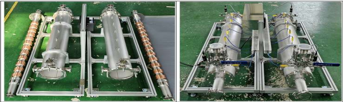
< 4L급 디젤 엔진 연계용 CO2 흡탈착 시스템 제작 사진 >
