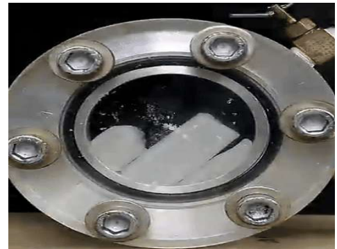
< Solid CO 2 저장 및 하역을 위한 용기와 하역시스템 검증 실험 진행 >
