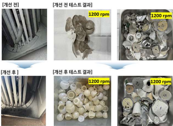
< 임팩트크러셔 내부 날 간격 개선 전/후 테스트 결과 >
