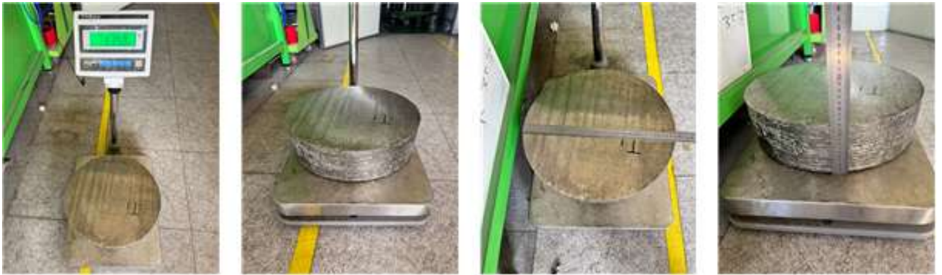
< 전자빔 용해공정 활용 50kg 이상급 Ti 잉곳 제조 >
