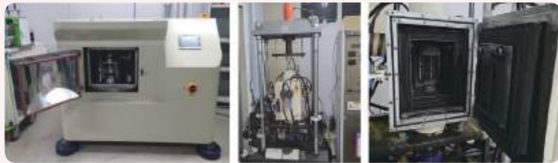
Planetary milling(좌), Hot Press(중), Hot press 내부 단열재 개선 모습(우)
