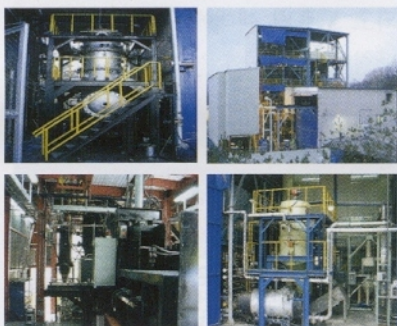
지난 1993년부터 가스화 응용에 관한 연구를 지속적으로 해온 플랜트엔지니어링센터에서는 고온·고압의 석탄가스화 연구로부터 축적된 가스화응용에 대한 기반기술을 하수슬러지 및 생활폐기물 처리에 성공적으로 적용해 각각 환경부 신기술로 지정 받았다. 사진은 시계방향으로 가연성 폐기물 가스화 응용설비(국가지정 연구실), 석탄가스화 응용설비, 슬러지 연소/응용설비, 도시 및 산업 폐기물 가스화 응용설비.
